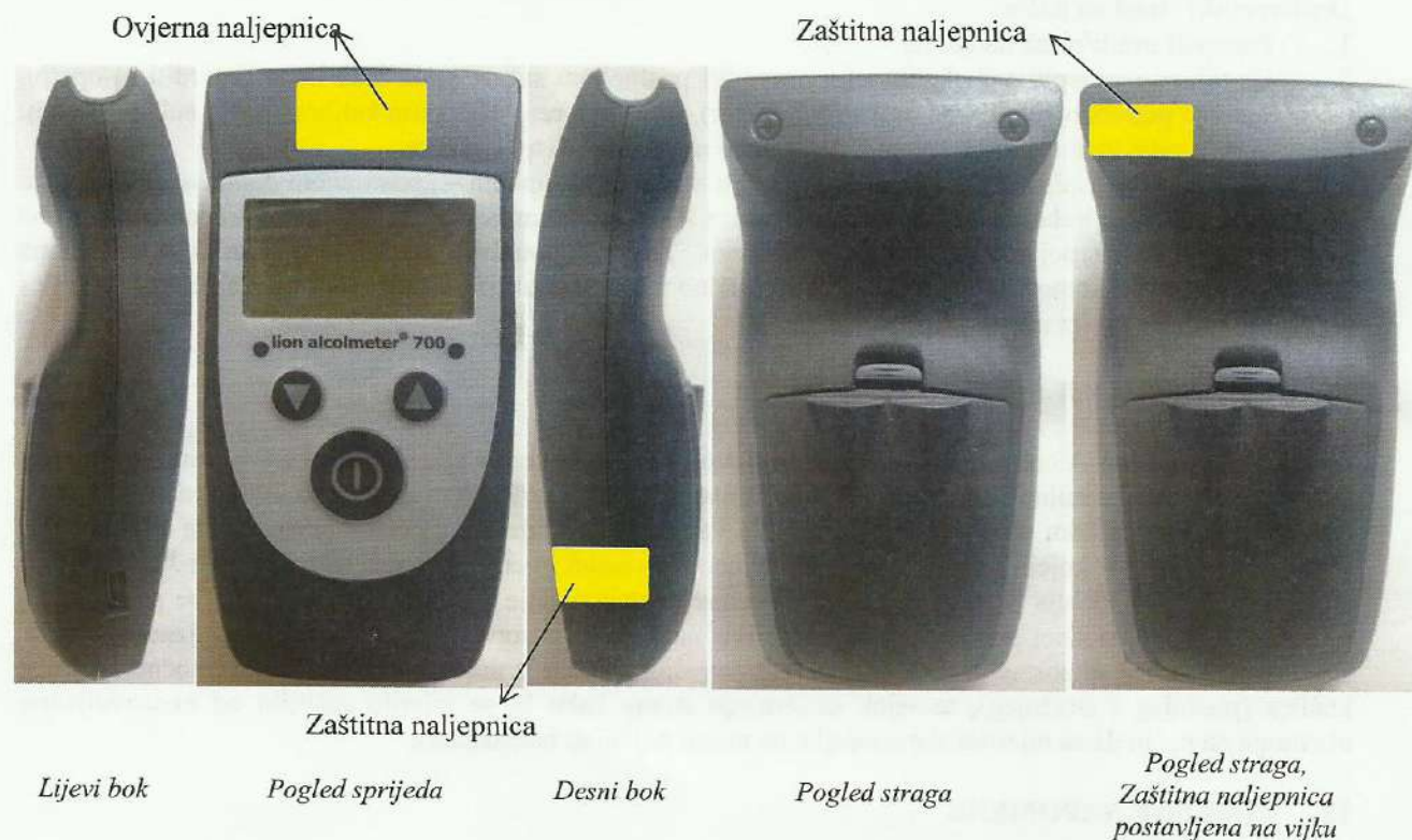
Slika 1. Višestrani prikaz uređaja Lion Alcolmeter® 700
